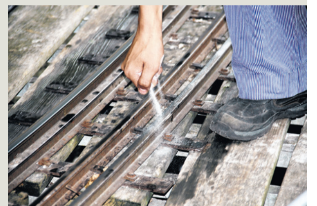
Weil es kurz regnete, half nur noch Sand, um den Lokomotiven die Steigungen zu ermöglichen.
