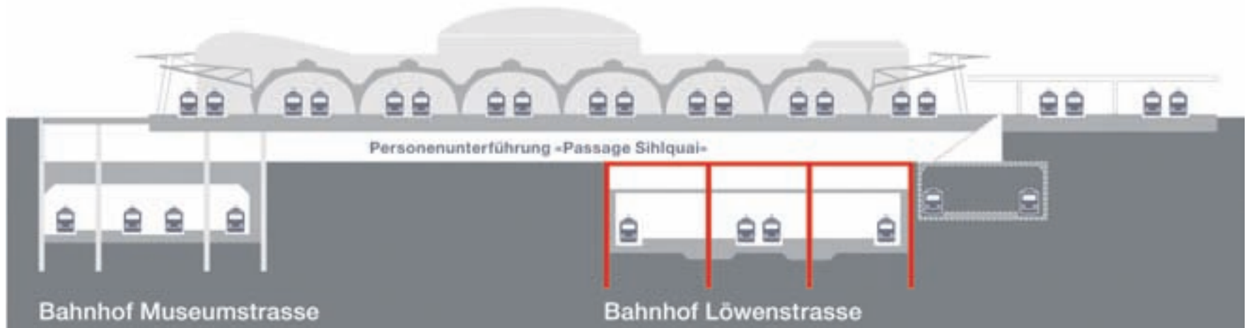
Einer oben, zwei unten. Der neue Bahnhof Löwenstrasse ist unter dem Hauptbahnhof und ein paar Dutzend Meter neben dem Bahnhof Museumstrasse. Grafik SBB
